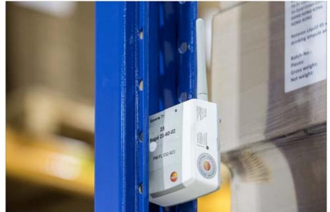
Bild 7: Die Messwerte der ersten Heiz- und Kühlperiode lieferten ein erfreuliches Ergebnis: Über die gesamte Raumhöhe von sieben Metern – hier waren Messpunkte in drei Ebenen angebracht – trat im Lagerbereich von Ursapharm keine Temperaturabweichung von mehr als 1 °C auf. Dies entspricht damit den strengen Vorgaben von GMP und FDA.
