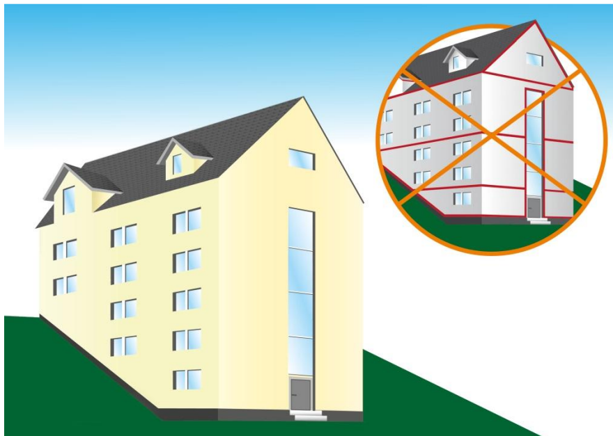
Bild 4: Patchwork-Arbeiten an der Fassade und die damit verbundenen Risiken bei der Ausführung müssen nicht sein: PU WDV-Systeme ermöglichen eine lückenlose Dämmung von der Bodenplatte bis zum Dachfirst.
