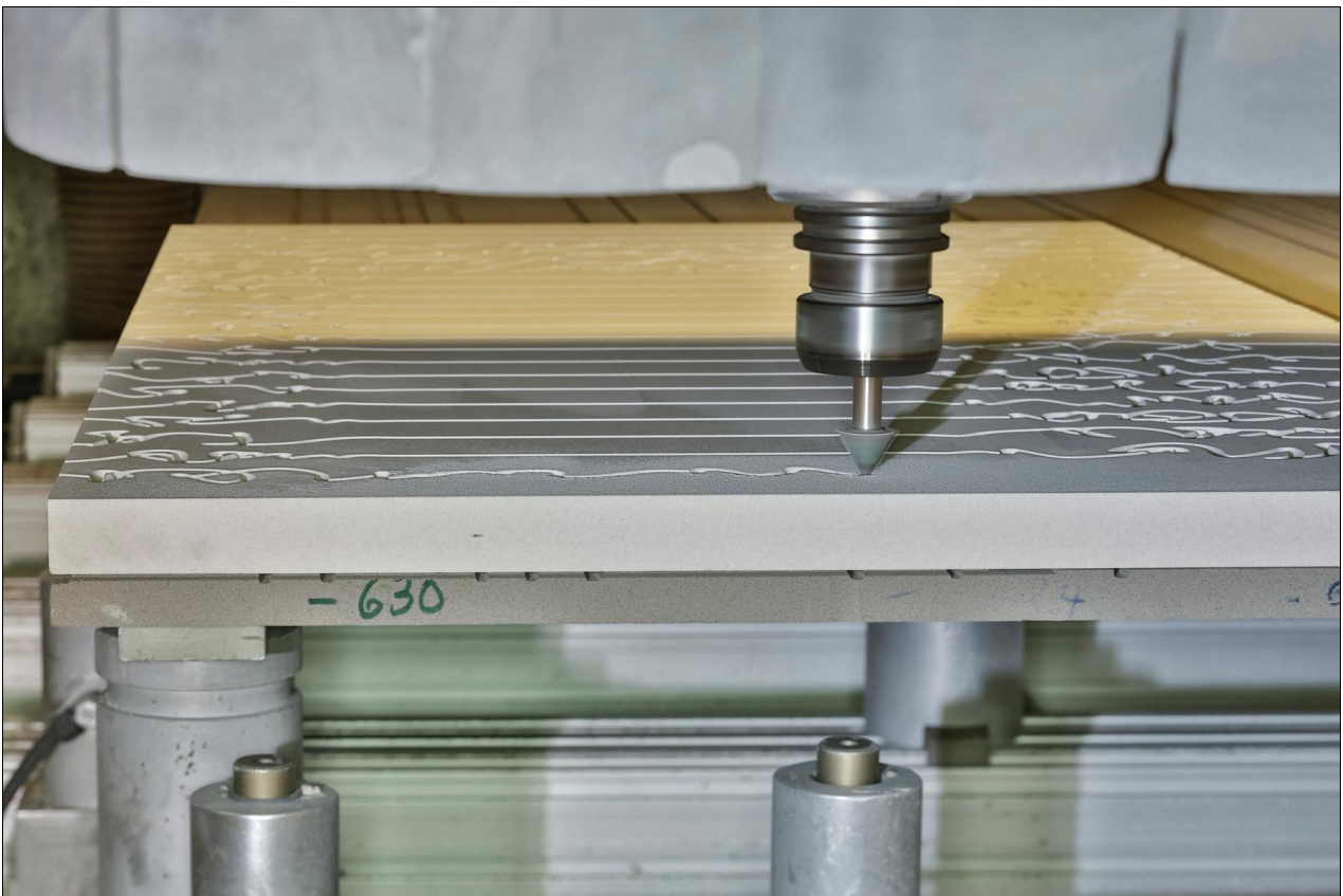
Bild 3: Der mineralische Leichtbaustoff Verolith liegt zunächst als gestaltloser Rohling vor. CNC-Fräsen verleihen dem Material seine dreidimensionale Fassadenoberfläche. Die massiven Werkstücke werden nach Vorgabe des Planers auf dem Fassadendämmsystem appliziert und anschließend beschichtet.
