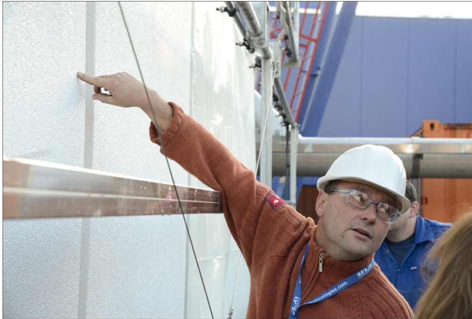
Bild 3: Fassadendämmsysteme von Sto werden wieder und wieder allen vorgeschriebenen und zahlreichen freiwilligen Qualitätstests unterzogen, wie hier auf dem fibag-Simultanprüfstand.
