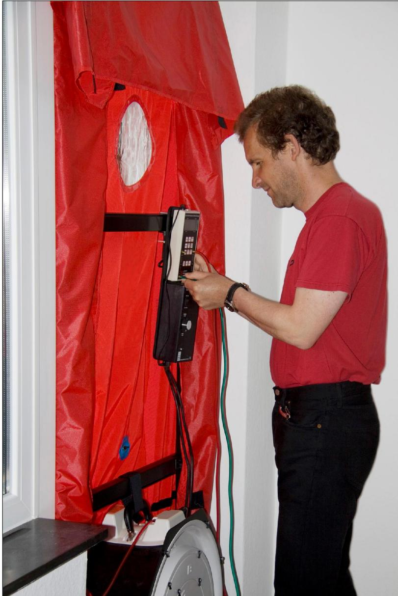
**Bild 2: Die neue EnEV schreibt für Luftdurchlässigkeitsmessungen Verfahren B der DIN EN 13829 vor.** Entgegen eines noch immer weit verbreiteten Irrglaubens steht „B“ allerdings nicht für „in der Bauphase“, sondern bezieht sich auf das Vorgehen bei der Gebäudepräparation.
