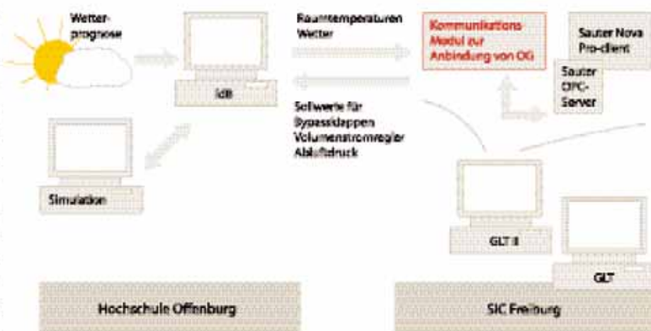
Anbindung der dynamischen Betriebsführung an die Gebäudeautomation
