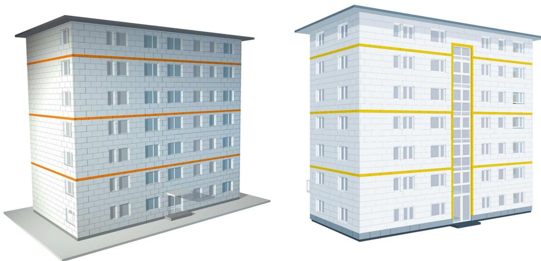
*Brandriegel sind bei mehrgeschossigen Gebäuden vorgeschrieben. Sie sind aus nichtbrennbaren Dämmstoffen alle zwei Geschosse vorzusehen. Erfordern spezielle bauliche Eigenheiten höheren Schutz, werden die Vorgaben erhöht – im Beispiel um das verglaste Treppenhaus.*
